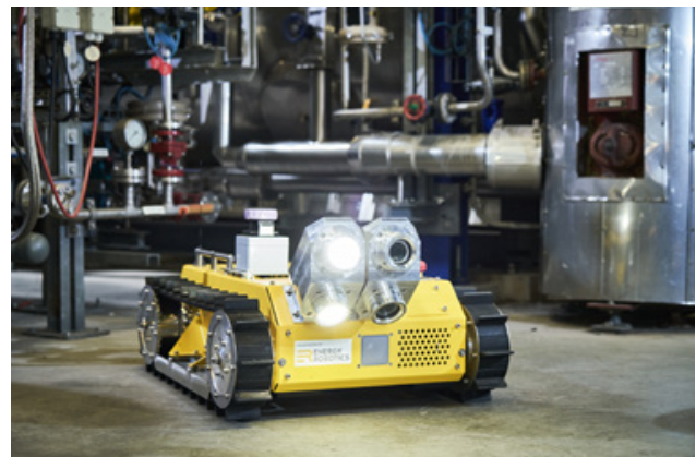
شکل ۲: ربات مدل ۱- ExR-ExRobotics ساخت شرکت ExRobotics در بسیاری از شرکت‌های گاز از جمله در چندین کارخانه‌ی شرکت‌شل مورد بهره‌برداری قرار گرفته است.
