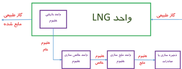
شکل ۲- شماتیک کارخانه LNG و واحد بازیابی هلیوم
