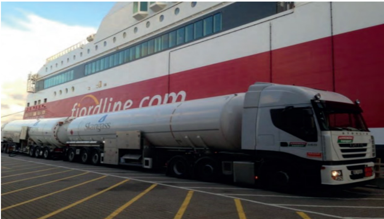
شکل ۲. سوختگیری از طریق سیستم انتقال از کامیون به کشتی با استفاده همزمان از دو تریلر حمل LNG (ایستگاه سوختگیری Skangass نروژ)
